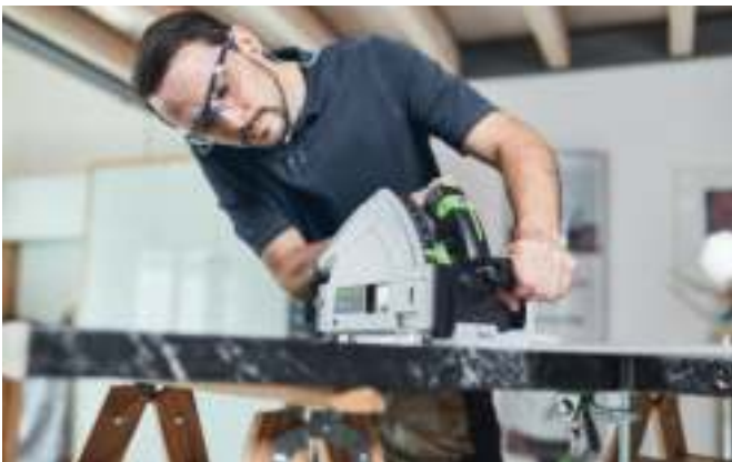
优质的开槽 例如在厨房工作台上，必须先划线然后精确切割。此时，能透过透明视窗清晰地看到边角处的末端标记。
